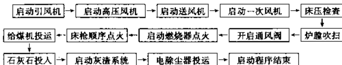
图 5-12 循环流化床锅炉典型顺序启动流程
